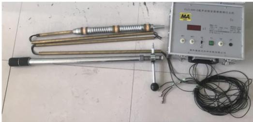
图 1 CLC1000-C 超声波围岩裂隙探测仪
